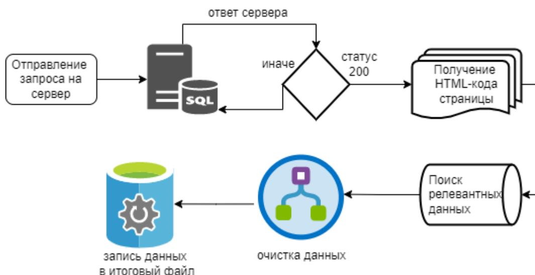
Рисунок 4.2 – Подробная схема построенного парсера.
